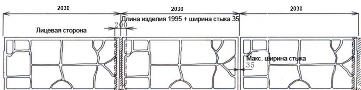
Рисунок 27 - Варианты регулировки длины шириной стыков.
