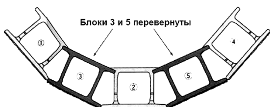
Рисунок 29 (b) - Пример выполнения выгнутой кривой ( R=20 м)
