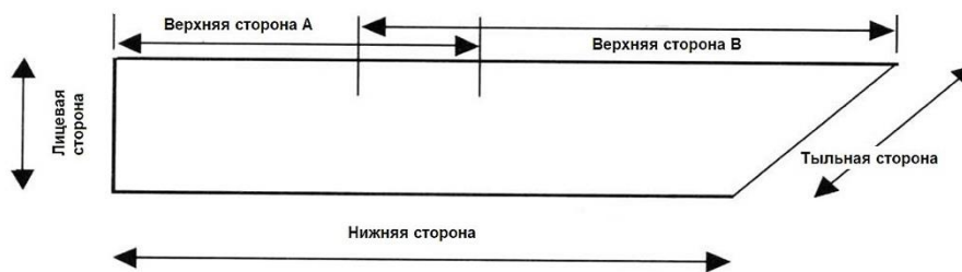
Рисунок 4 - Обозначения сторон стяжной сетки
